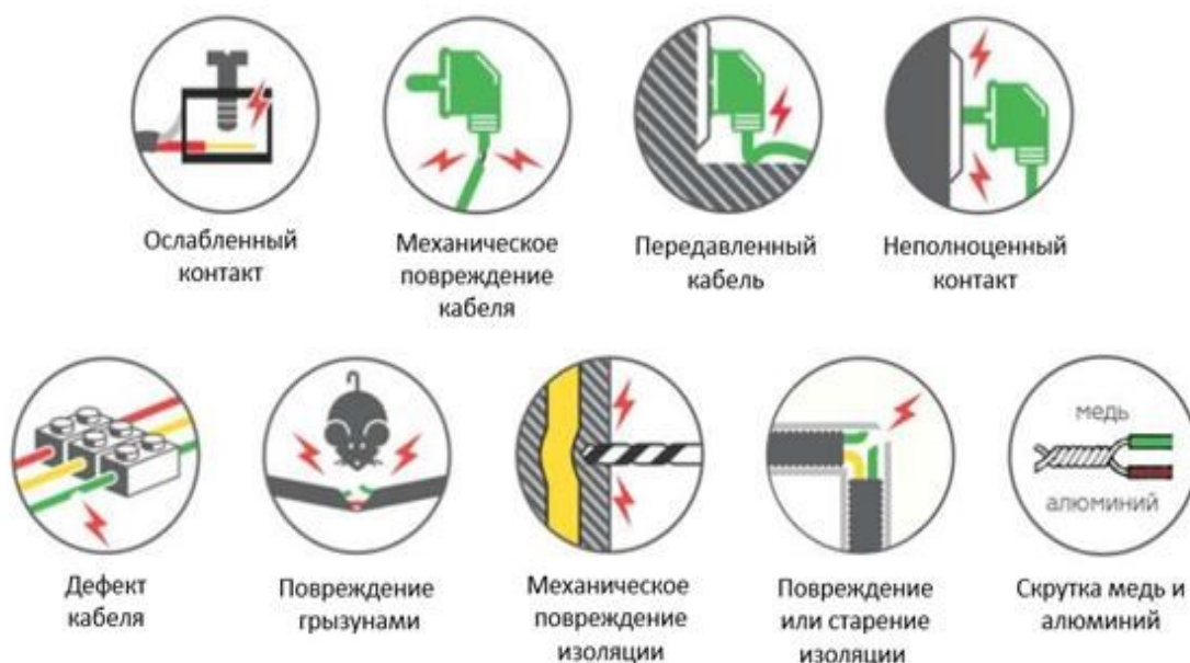
Рисунок 6. Возможные причины искрения в электропроводке
