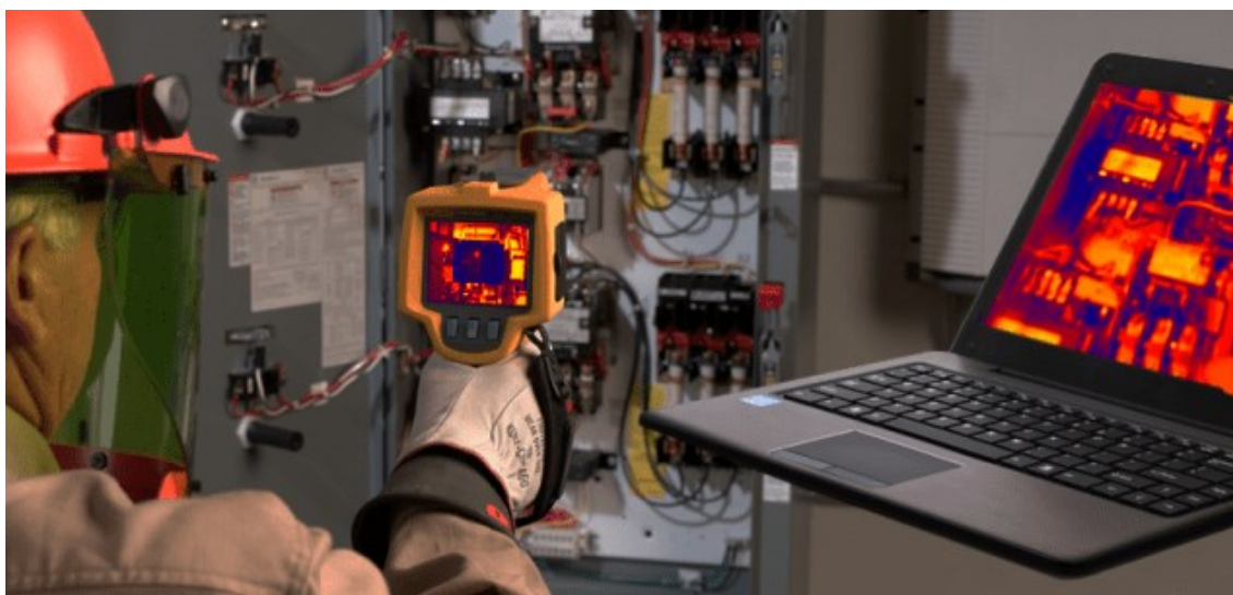
Рисунок 20. Пример проведения тепловизионного контроля электрошкафа
